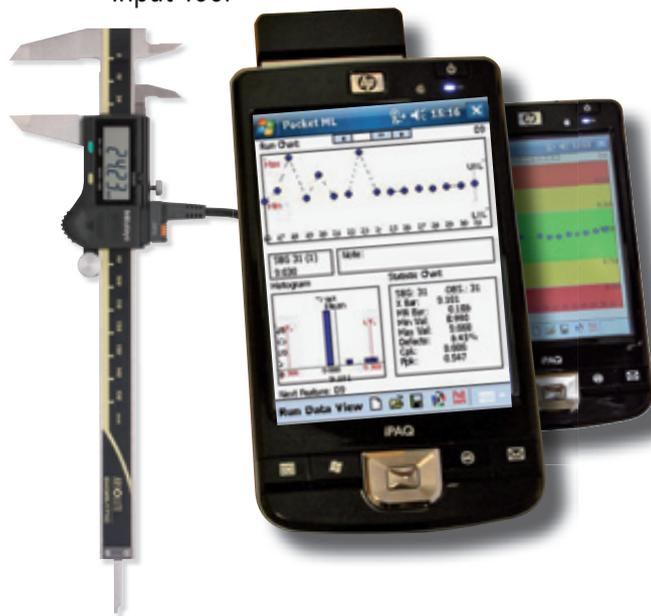
**Pocket ML erleichtert das Messen mit Handmessgeräten besonders dann erheblich, wenn der Messvorgang nicht an der Werkbank oder am Schreibtisch möglich ist.**
