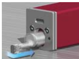
R-Vorschub Vor Beginn der Messung ist das Tastsystem nicht in Kontakt mit dem Werkstück. Erst nach dem Start der Messung senkt sich das Tastsystem, während der Vorschub in X-Messrichtung verfährt, auf die Werkstückoberfläche. Bei dem Zurückfahren hebt das Tastsystem vor Erreichen der Messstart-Position wieder von der Werkstückoberfläche ab.
