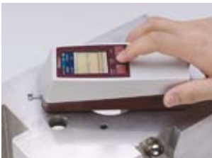
Kompaktsystem mit integriertem Vorschub
