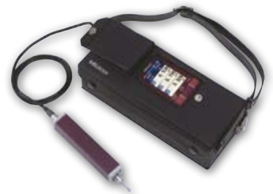
S-Vorschub Für Sondermessaufgaben entwickelt, dient ausschließlich zum Messen in Y-Richtung (quer zur Standardmessrichtung)
