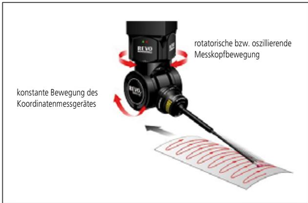
Mit der Sweep-Scanning Funktion lassen sich Flächen mit dem Revo<sup>®</sup> besonders effizient erfassen. Durch die Lernfunktion des Dialoges lässt sich die Funktion auch ohne ein CAD-Modell des Werkstückes umsetzen.
